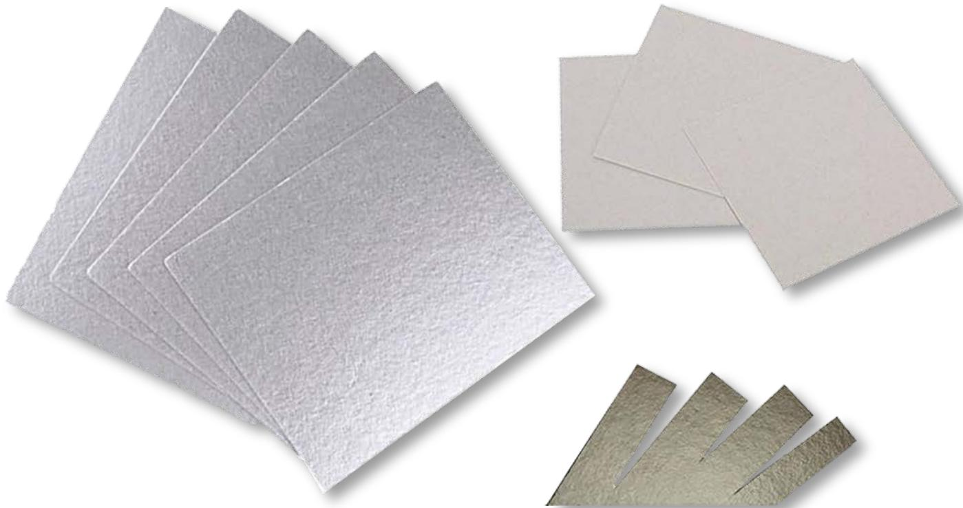
Il prodotto è uno stratificato rigido, composto da mica Muscovite impregnata con resina siliconica , pressata a caldo. Oltre a fornire un eccezionale isolamento elettrico ad alta temperatura, possiede buone caratteristiche meccaniche.
