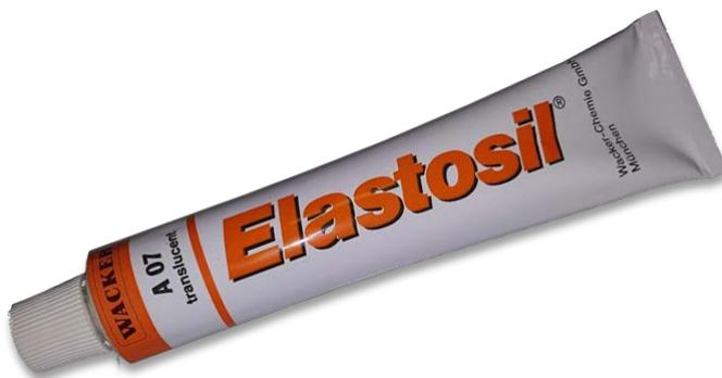
ELASTOSIL® A07 è una gomma siliconica tipo RTV-1 a base di solvente. Si indurisce a temperatura ambiente per reazione con l'umidità dell'aria formando un rivestimento in silicone flessibile. Più elevata è la temperatura, più veloce è anche la reazione chimica di indurimento (reticolazione). Durante la reticolazione si scinde un'ammina organica. Ideale per l'incollaggio, la sigillatura e l'incapsulamento.
