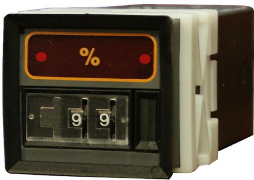
Il percentualizzatore modello THRETZ03 è un regolatore di temperatura elettronico ad impostazione digitale. Permette di regolare la temperatura delle resistenze, senza l'utilizzo di termocoppie. Tramite due preselettori digirìtali, varia da 0 a 99% l'accensione / spegnimento di un relè statico (vedi "Gruppi statici") nel tempo massimo di 1,3 sec. Dispone di due segnalazioni luminose a Led che indicano:
