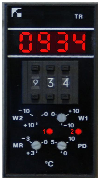
L'apparecchio modello T2/K/PD1199/2R è un regolatore di temperatura elettronico formato mm. 48 x 96 x 120 .
